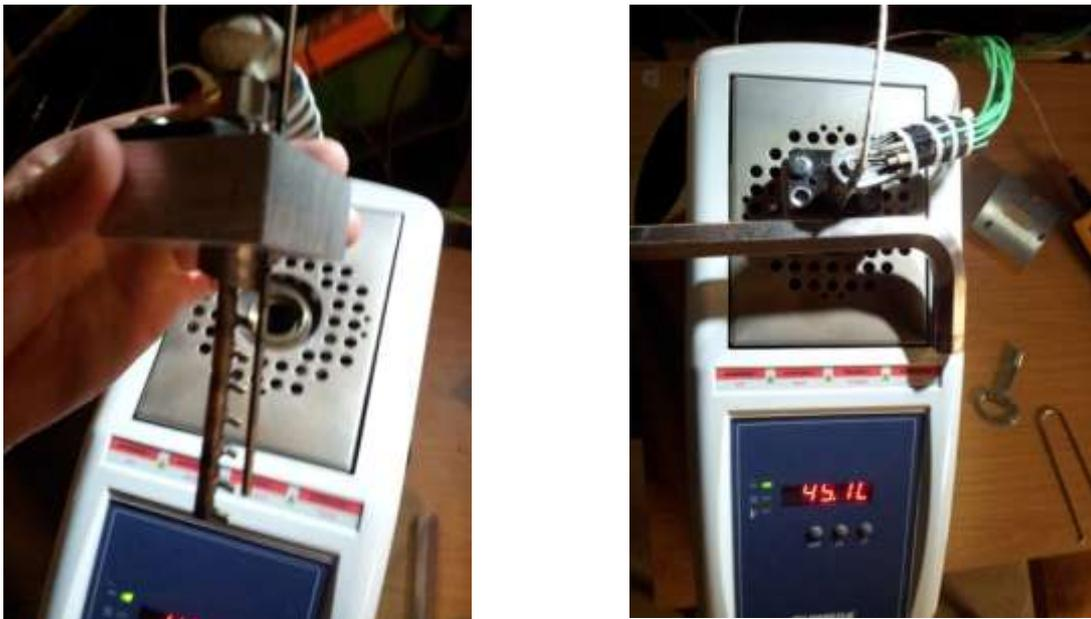
Abb. 13: Rake F und Pt100 bei Kalibrierung in Befestigung(links); Kalibrierung desselben Rakes (rechts)
