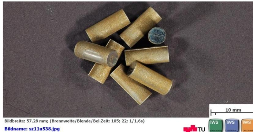
Abb. 4-5: Dilatometerproben, eine davon bereits angeschliffen
