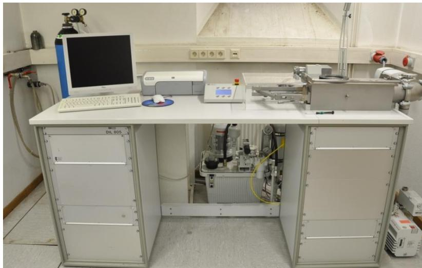
Abb. 4-1: Abschreck- bzw. Umformdilatometer BÄHR Dil805A/D
