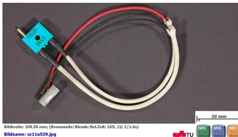
Abb. 4-6: vorbereitete Dilatometerprobe
