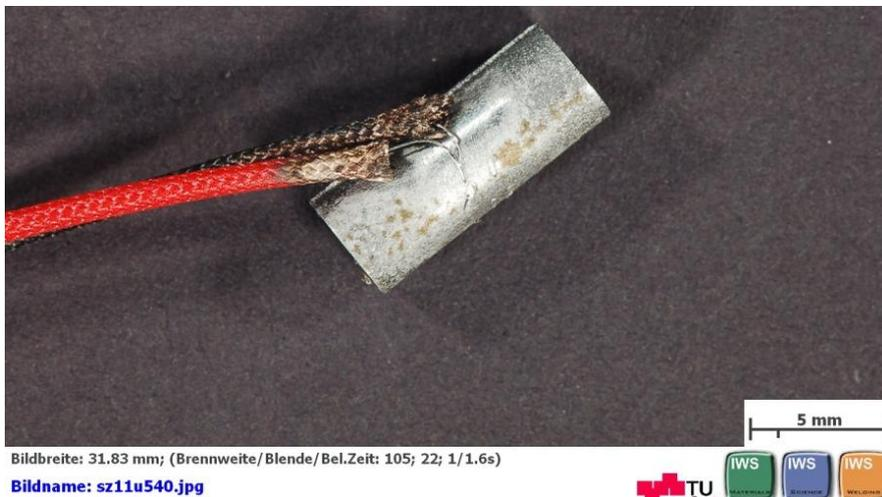
Abb. 4-8: Probe unmittelbar nach dem Dilatometerversuch, mit Helium abgeschreckt
