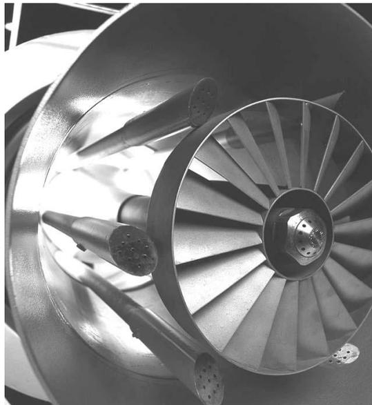
**Abb. 2-3: Drallgitter und Gaslanzen des LOW-NO<sub>x</sub> Brenners (Baukal 2004)**
