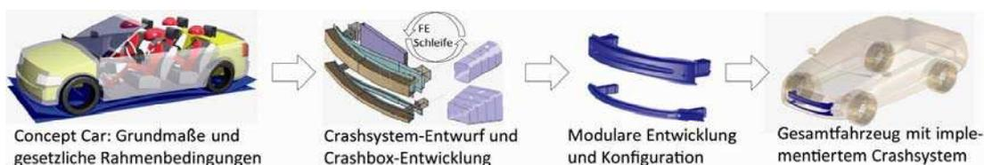
Abbildung 1-2: Entwicklungsprozess eines Fahrzeug-Crashsystems, vgl. [3]
