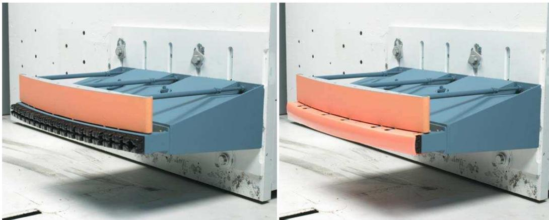
Abbildung 5-20: RCAR Barriere ohne bzw. mit Abdeckung, [13]
