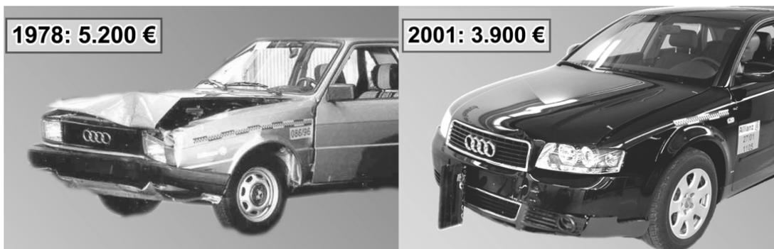
Abbildung 1-11: Höhe der Reparaturkosten nach einem Low-Speed Crash Test, [17]
