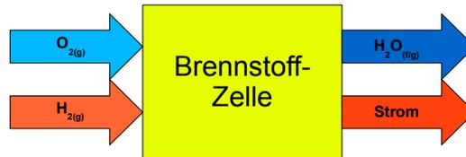
Abbildung 2.1: Konzept einer Wasserstoff-Sauerstoff-Brennstoffzelle, nach [1]
