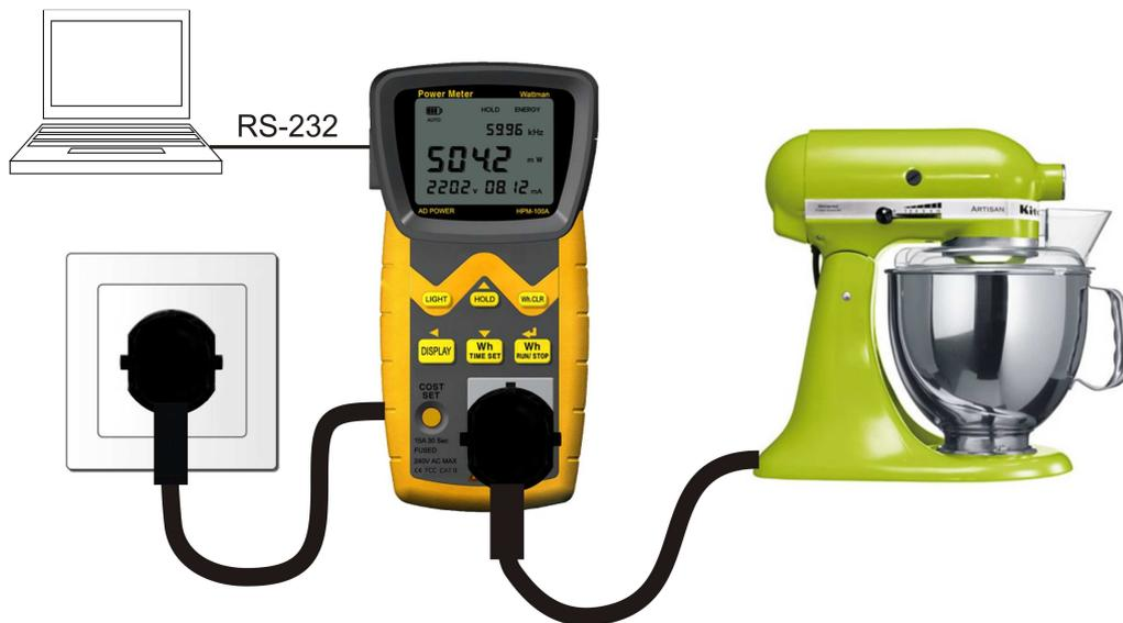
Abbildung 4.14: Messprinzip Wattman HPM-100A
