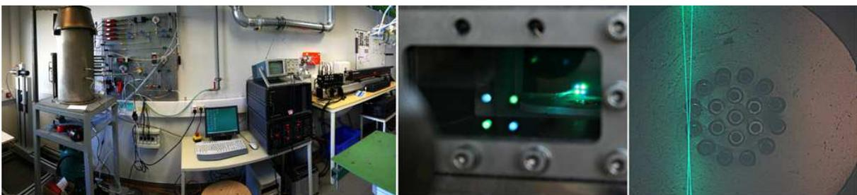
Abbildung 11: Gasgeschwindigkeit Analyse-Gerät mit Laser Doppler Anemometrie Verfahren (LDA)
