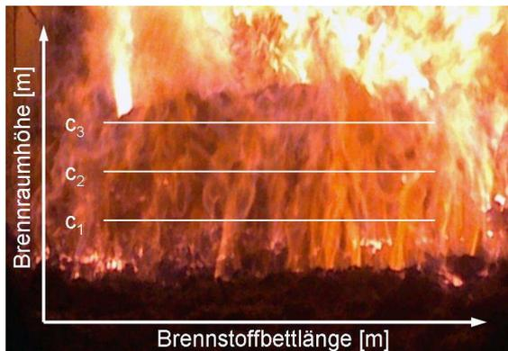
Abbildung 1: Schematische Darstellung eines Berechnungsprofils für eine Schüttung ohne Strähnenbildung
