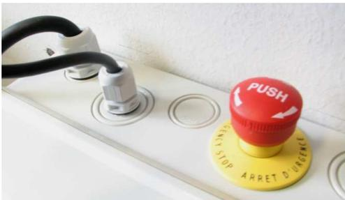
Abbildung 50: Not-Aus Schalter für Versuchsaufbau
