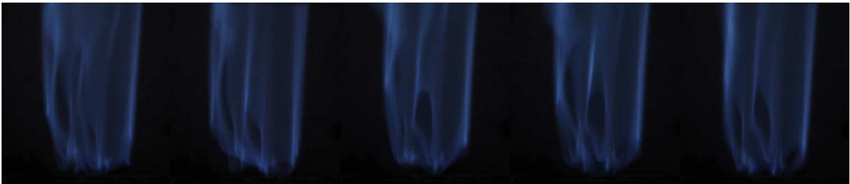
Abbildung 68: Schiefstellung in der Flamme ohne Flammenabhebung mit  $v_{\text{Gas}}=2$  m/s
