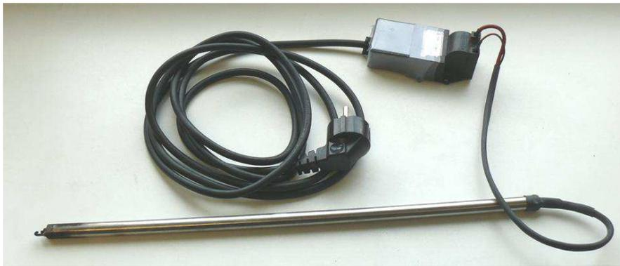
Abbildung 46: Gesamtansicht der elektrischen Zündeinheit
