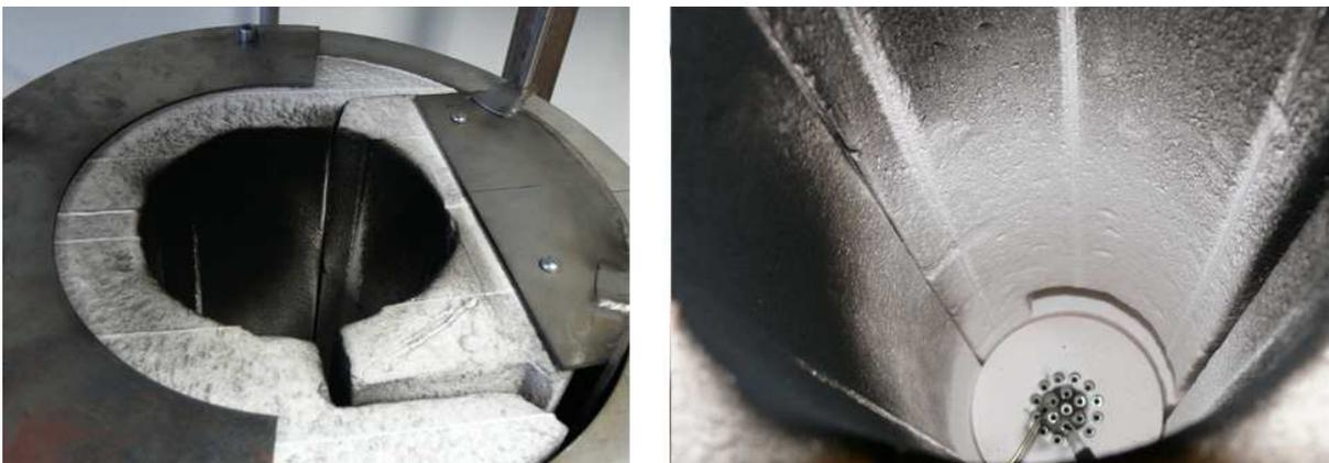
Abbildung 33: Keramikfaserdämmung nach erstem Feuertest
