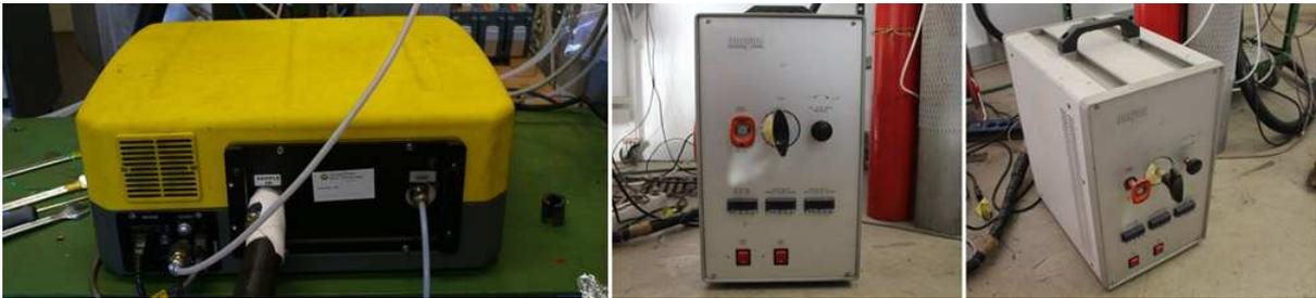
Abbildung 9: Gaskonzentrations Analyse-Gerät mit Fourier-Transformations-Infrarot-Spektroskopie-Verfahren (FTIR) und Pumpe
