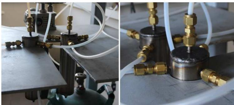
Abbildung 52: Gassplittereinheit vor Gas-Luft Verteiler
