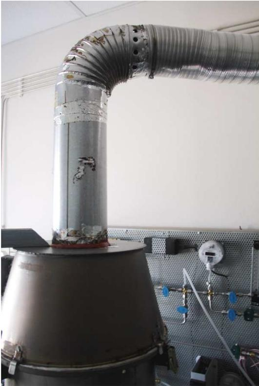
Abbildung 55: Absaughaube für Entwicklungsstufe 2 Versuchsaufbau
