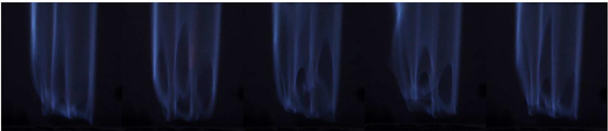
Abbildung 69: Schiefstellung in der Flamme und teilweise Flammenabhebung mit  $v_{\text{Gas}}=3$  m/s
