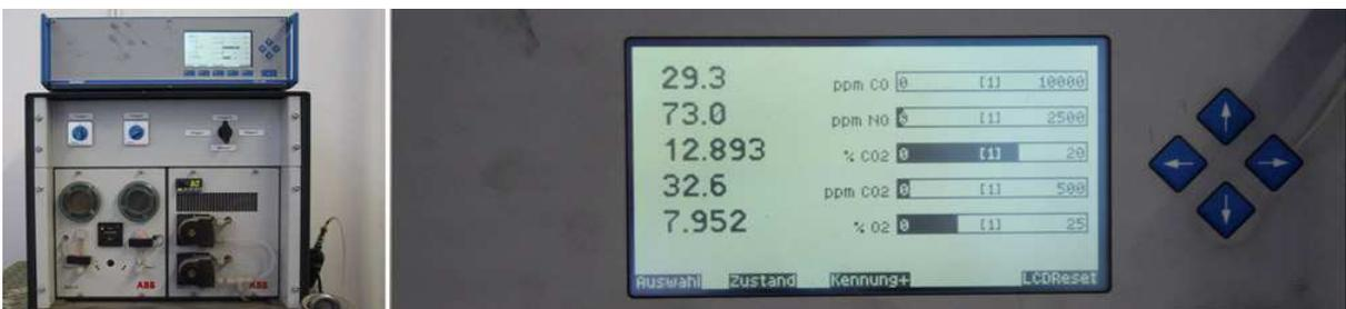
Abbildung 10: Gaskonzentrations Analyse-Gerät mit Infrarot-Absorptions- und paramagnetischem Verfahren (RGA)
