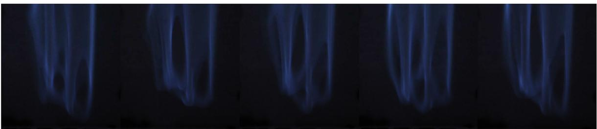
Abbildung 70: Schiefstellung in der Flamme und Flammenabhebung mit  $v_{\text{Gas}}=4$  m/s
