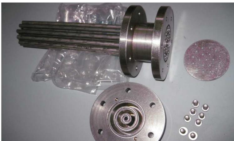
Abbildung 42: Gas- Luftverteiler Kammernansicht
