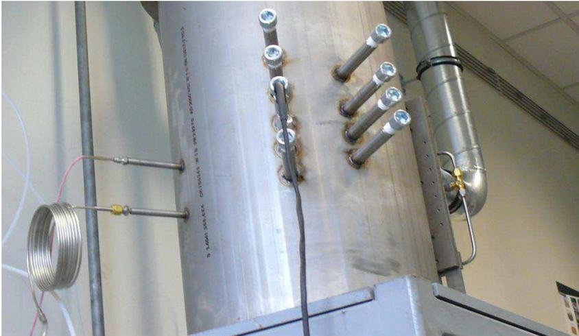
Abbildung 44: Überwachungsstutzen und Probenahmestutzen
