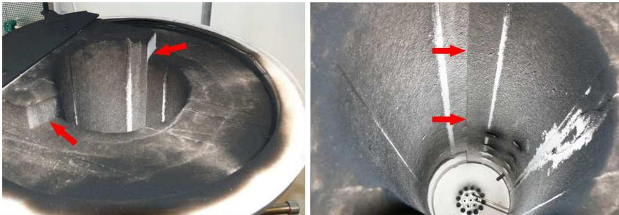
Abbildung 58: Keramikfaserdämmung nach Optimierungsanpassungen
