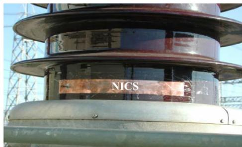
**Abbildung 73:** An der Porzellanoberfläche der Durchführung befestigtes Kupferband zur Signalabkopplung (NICS) [SET06]
