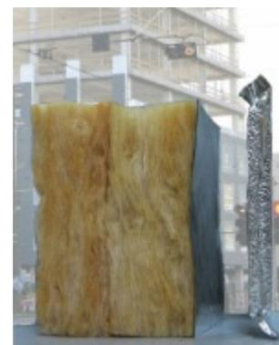
Abb.26 Mineralwolle zu Vakuum-Isolationspaneel
