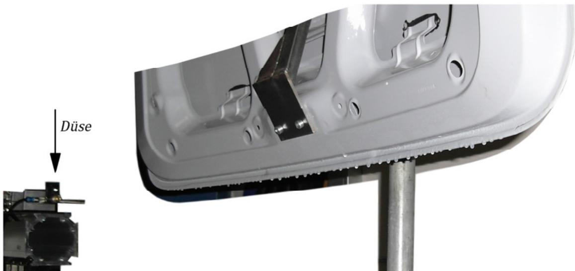
Abb. 5.23 Befeuchtete Heckklappe mit hängenden Tropfen vor der Anblasung
