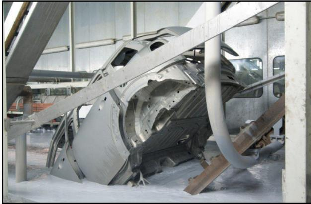
Abb. 1.1 Karosse beim Eintauchen in den Tauchlack (Foto: MAGNA Steyr Fahrzeugtechnik)
