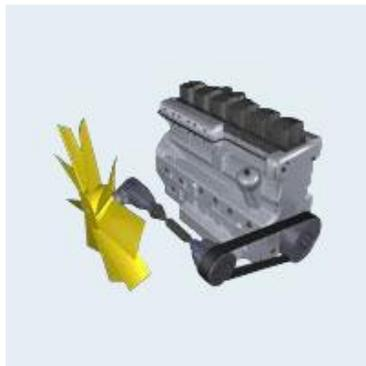
Abbildung 2-23: Lüfter-Antrieb mit elektromagnetischer Kupplung [17]
