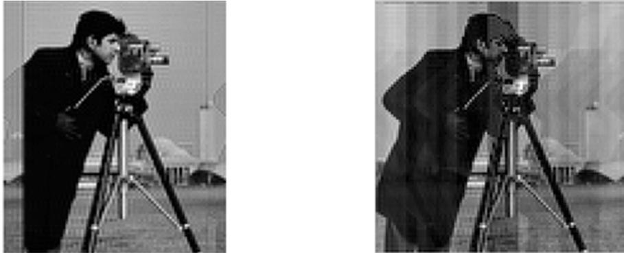
Abb. 3.13: Faltungsartefakte, da der k-Space in RO Richtung nicht korrekt abgetastet wurde. Links: gleiche Abstände 1:3:256, somit nur 86 Punkte; Rechts: Simulation mit 100 Punkten, aber die Abstände sind ungleichmäßig, (abwechselnd 2 und 3 Pixel).
