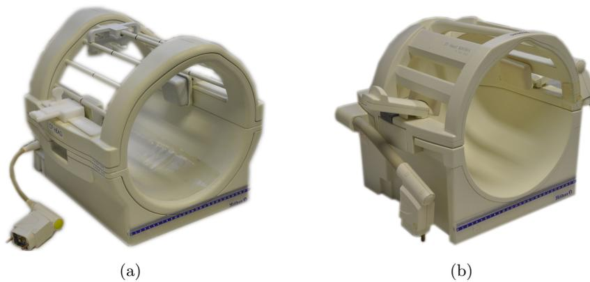
Abb. 3.2: Spulen, die für die Messungen verwendet wurden: a) Vogelkäfig-Spule; b) 12-Kanal Kopfspule
