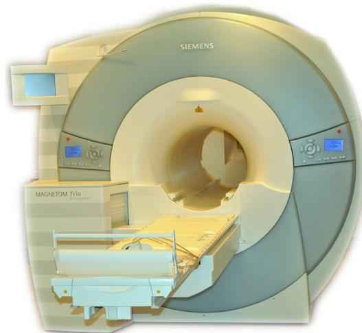
Abb. 3.1: Für die Messungen verwendeter MR-Scanner: Magnetom Trio - a Tim System - 3 T
