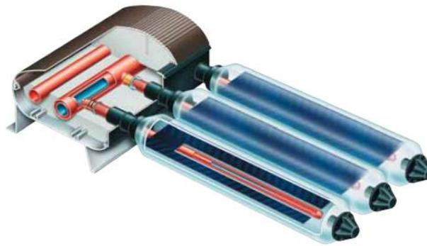
Abbildung 2-11 Direkt durchströmter Röhrenkollektor (Deutsche Gesellschaft für Sonnenenergie, 2008)
