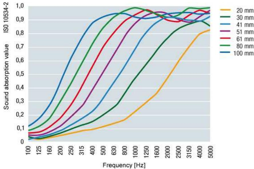
Fig. 3.26 Sound absorption value, (www.basotect.com, Jun. 2011)
