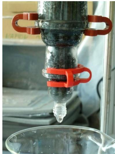
Abbildung 7-37: Aktivkohleabsorption Labormaßstab
