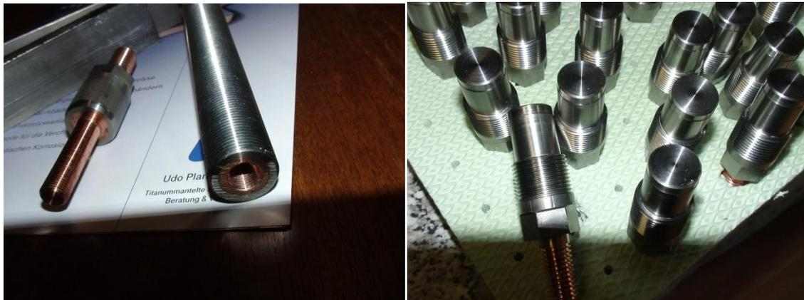
Abbildung 7-13: Titan-Kupfer Verbundwerkstoff Stromaufgeber
