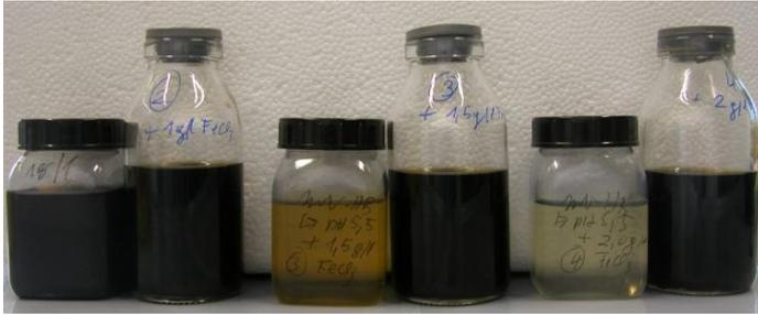
Abbildung 7-35: Fällung bei unterschiedlicher  $\text{FeCl}_3$ -Konzentration ( $c_{\text{FeCl}_3}=1$  [g/l]: Probe: 1 und 2,  $c_{\text{FeCl}_3}=1,5$  [g/l]: Probe: 3 und 4,  $c_{\text{FeCl}_3}=2$  [g/l]: Probe: 5 und 6) und pH-Wert (pH=5,5: Probe: 1,3 und 5, pH=8,8: Probe: 2,4 und 6), (Probennummerierung von links nach rechts)
