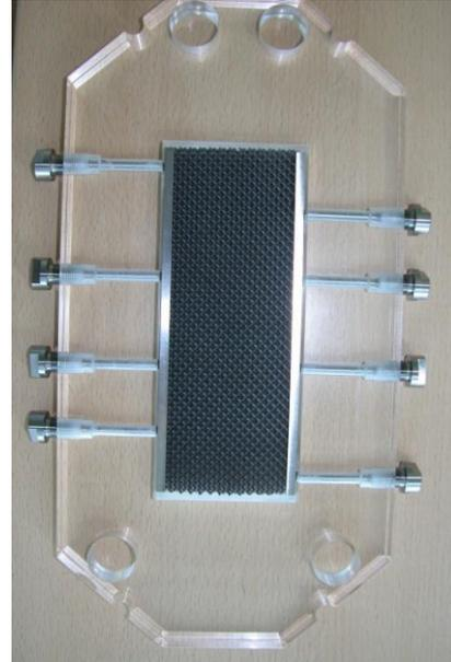
Abbildung 6-17: Kontaktierung 3D-BDD-Elektrode
