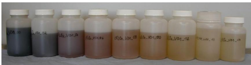
Abbildung 7-30: elektrochemische Behandlung von Deponiesickerwasser
