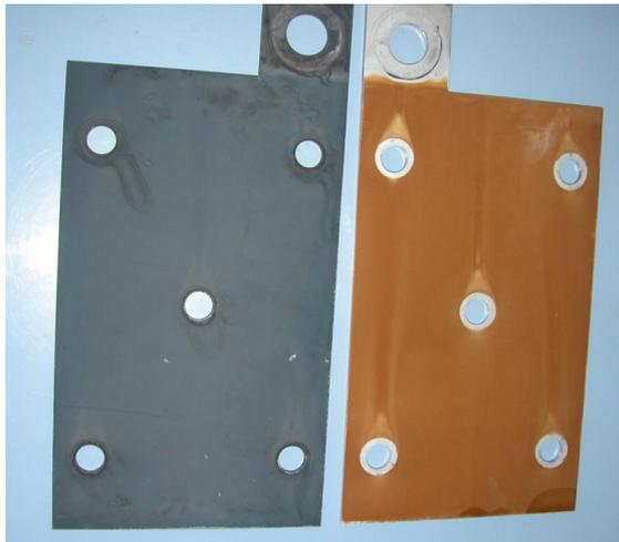
Abbildung 6-48: Ablagerung an der Kathode nach der Elektrolyse (links: Anode, rechts: Kathode)
