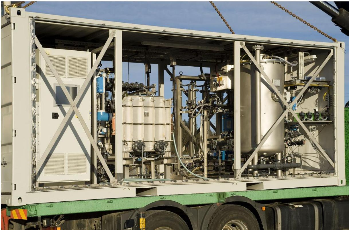
Abbildung 5-9: Mobile Pilotanlage für AOP-Versuche
