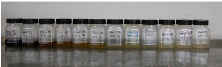
Abbildung 6-47: Elektrochemische Behandlung von Deponiesickerwasser
