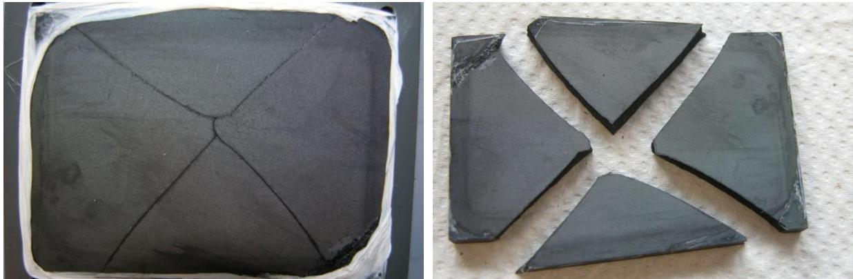
Abbildung 6-15: Beschädigung PACVD-Elektrode
