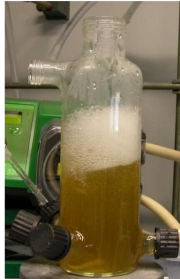
Abbildung 6-36: Schaumbildung bei der Elektrolyse
