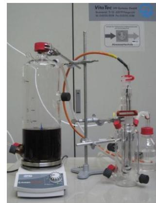
Abbildung 5-8: Schematischer Aufbau Ozonierung
