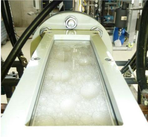
Abbildung 7-21: Gasblasenentwicklung in der Zelle, Stromdichte = 1500 [A/m<sup>2</sup>]
