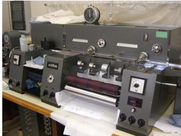
**Abbildung 2.4** Diese Abbildung zeigt das Prüfbau Probedruckgerät, wie es am Institut für Papier-, Zellstoff- und Fasertechnik in Verwendung ist. Es verfügt über zwei aufeinanderfolgende Druckwerke sowie vier Einfärbewerke.
