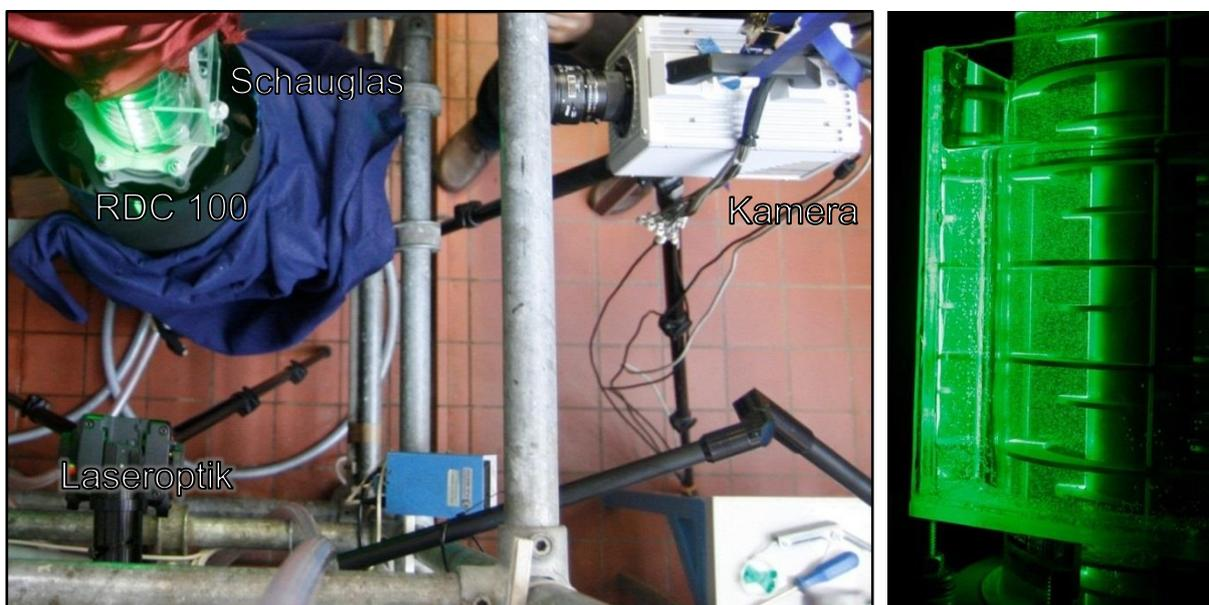
**Abbildung 2-7: Versuchsaufbau Particle Image Velocimetry.**
