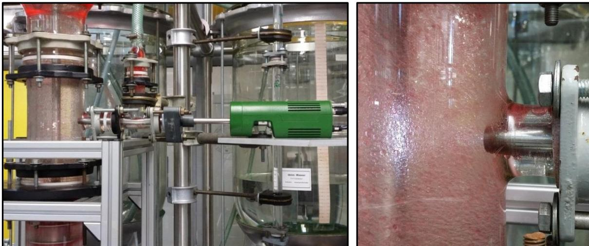
**Abbildung 4-11: Versuchsaufbau der endoskopischen TGV-Messung nach 1[m] aktiver Höhe.**
