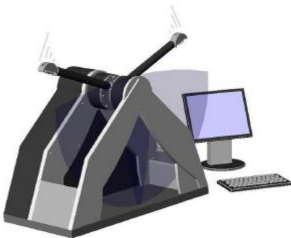
**Abbildung 4.6: IMPETUS II, Versuchsanlage für die dynamische Materialcharakterisierung**
