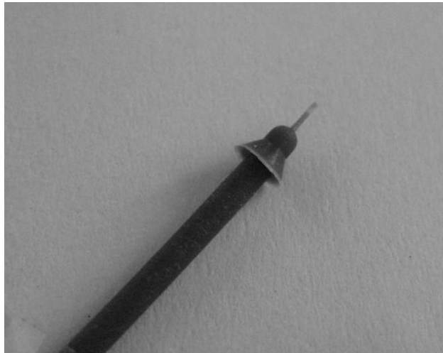
Abbildung 14: Spritzlochnegativform mittels Silikonabdrucktechnik
