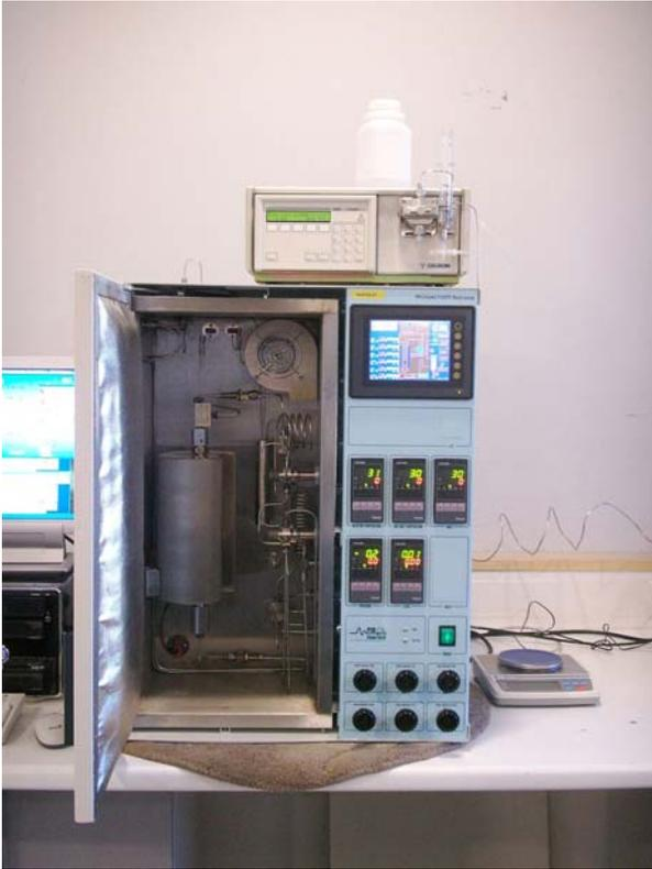
Abbildung 69: Teststand für Katalysator und Mikroreaktoruntersuchungen.
