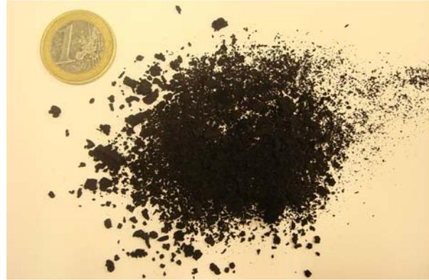
**Abbildung 76: Koksbildung bei Leerrohrversuch mit Inconel-Thermoelement**
