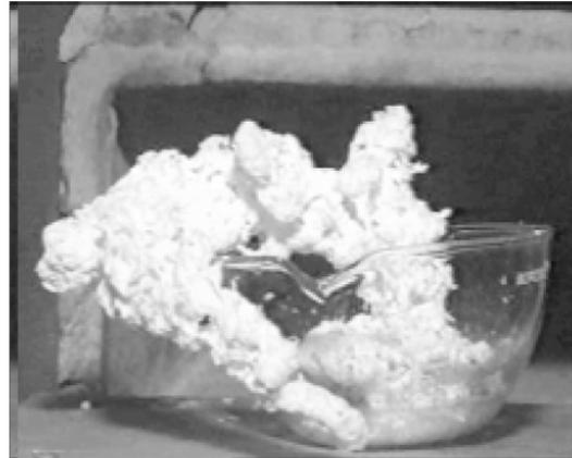
Abbildung 48: Feststoffentstehung bei der Solution-Combustion-Synthese [142]
