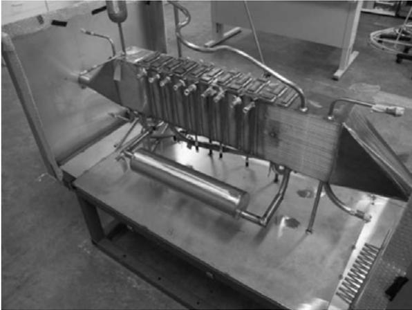
Abbildung 27: 5kW-Mikroreformer für Methan auf Basis des Multiple-Adiabate-Betten-Reaktor [67]
