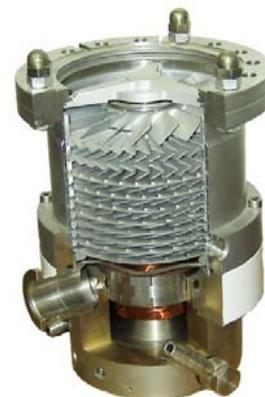
Abbildung 89: Turbomolekularpumpe (Quelle: Wikipedia)
