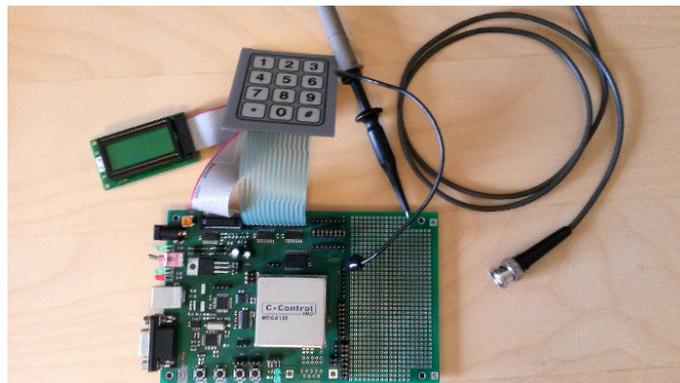
**Abbildung 3.2:** Der verwendete C-Control PRO Mega 128 auf dem C-Control Projectboard Pro mit angeschlossenem Koaxialkabel.
