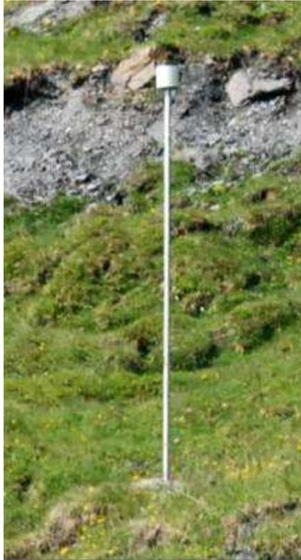
Abbildung 13: Zylinder-Ziel, zur besseren Sichtbarkeit auf einer 2 m langen Aluminium-Stange montiert.
