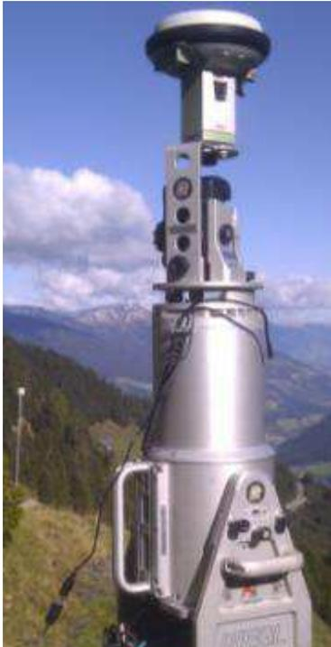
Abbildung 25: LMS Z620 mit GNSS-Adapter, Leica Viva GS15 und Zylinder-Reflektor im Hintergrund.
