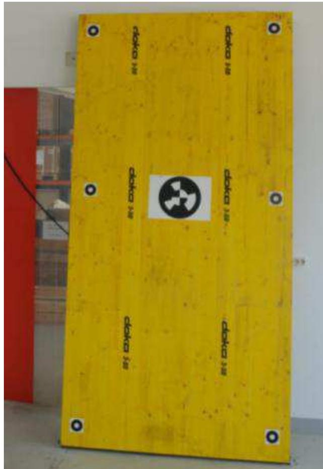
Abbildung 17: Target 3 mit Zielmarken. Die Planarität der Platte wurde mittels kalibrierter Metallleiste überprüft. Foto M. Rathofer, Juni 2011.
