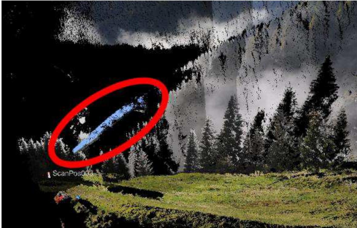
Abbildung 11: Gemessene Punkte im Nebel bei der Scanposition bei den Hütten (SP4). Das Bild ist aus der fototexturierten Punktwolke aus RiScanPro erstellt. Abbildung M. Rathofer.
