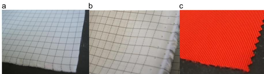
**Fig. 3: clean room textiles.** a) ION-NOSTAT VI.2. b) ION-NOSTAT V. c) Red knitted fabric with silver ion fiber.
