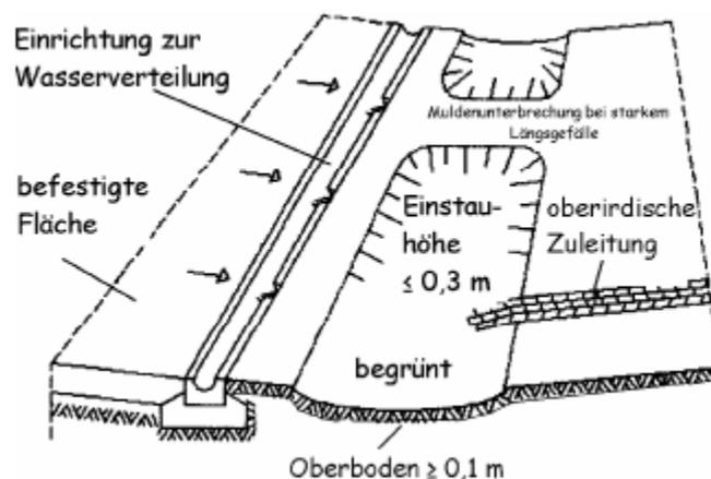
**Abbildung A-1: Kaskadenförmige Sickermulden (DWA-A 138, 2005)**
