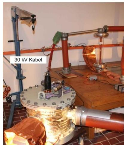
Abb. 7.2 30 kV Kabel, das den Kessel mit dem Baukastensystem verbindet
