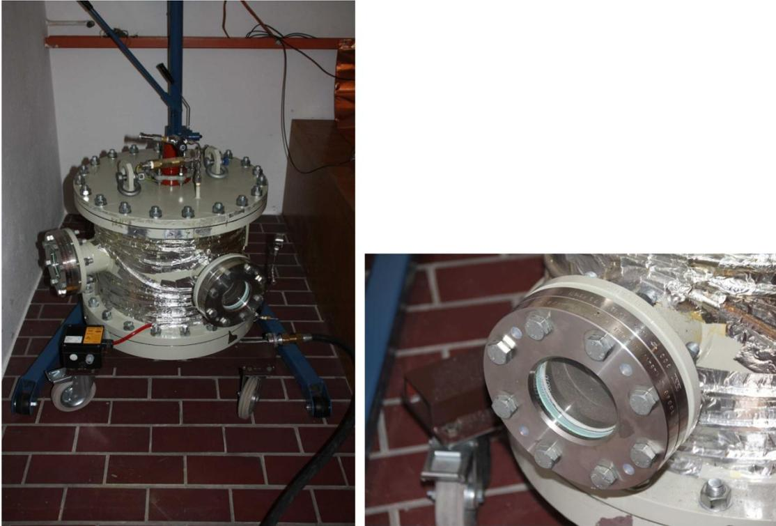
Abb. 6.10 a) Kessel und b) Sichtfenster des Kessels
