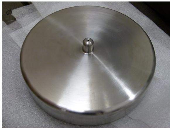
Abbildung 6.26: Kontaktierungsbohrung für die Hochspannungsdurchführung
