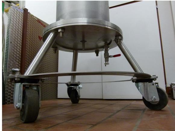
Abbildung 6.33: Hochspannungsanschluss und Ölablasshahn
