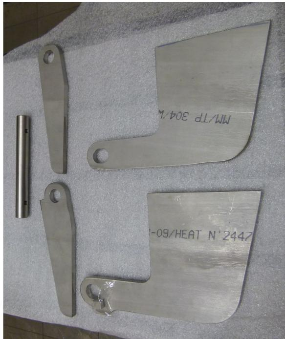
Abbildung 6.30: Scharnierteile
