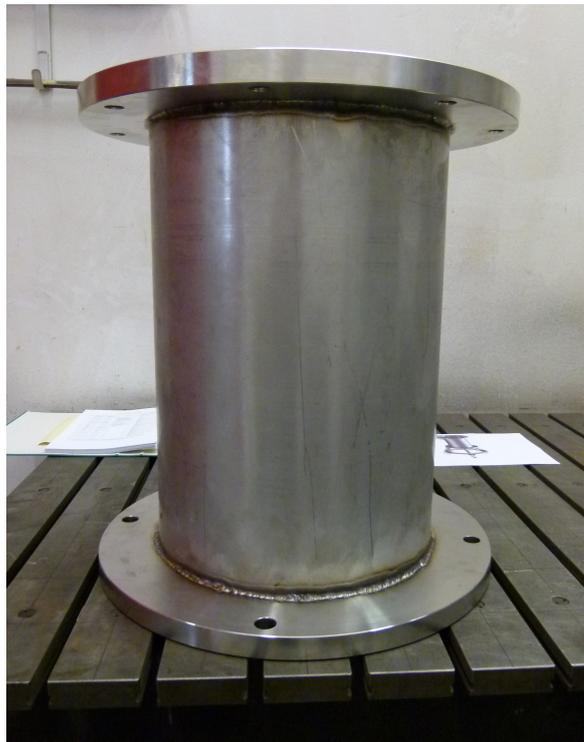
Abbildung 6.28: Kesselmantel fertig verschweißt
