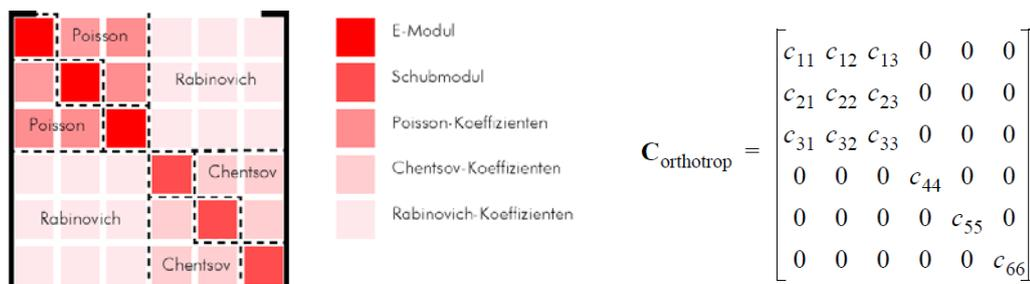
Abb. 15 Komponenten der Steifigkeitsmatrix bei orthotropen Materialverhalten (Schickhofer, 2006)
