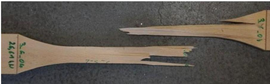
**Abbildung 112: typisches Versagensbild, Splitterbruch; 3-schichtig ohne Stoß**
