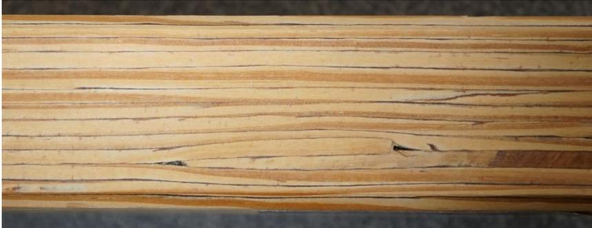
*Abbildung 64: Überlappungsstoß bei einer Furnierschichtholzplatte "Microlam"*
