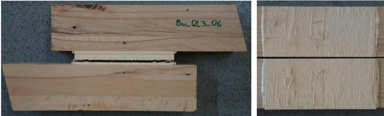
Abbildung 135: typische Versagensbilder, Buche 11-schichtig mit 2 Querlagen (Schicht 3, 9)
