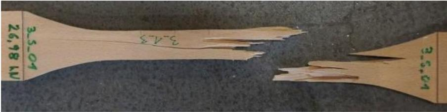
Abbildung 113: typisches Versagensbild, Splitterbruch; 3-schichtig mit Schäftung
