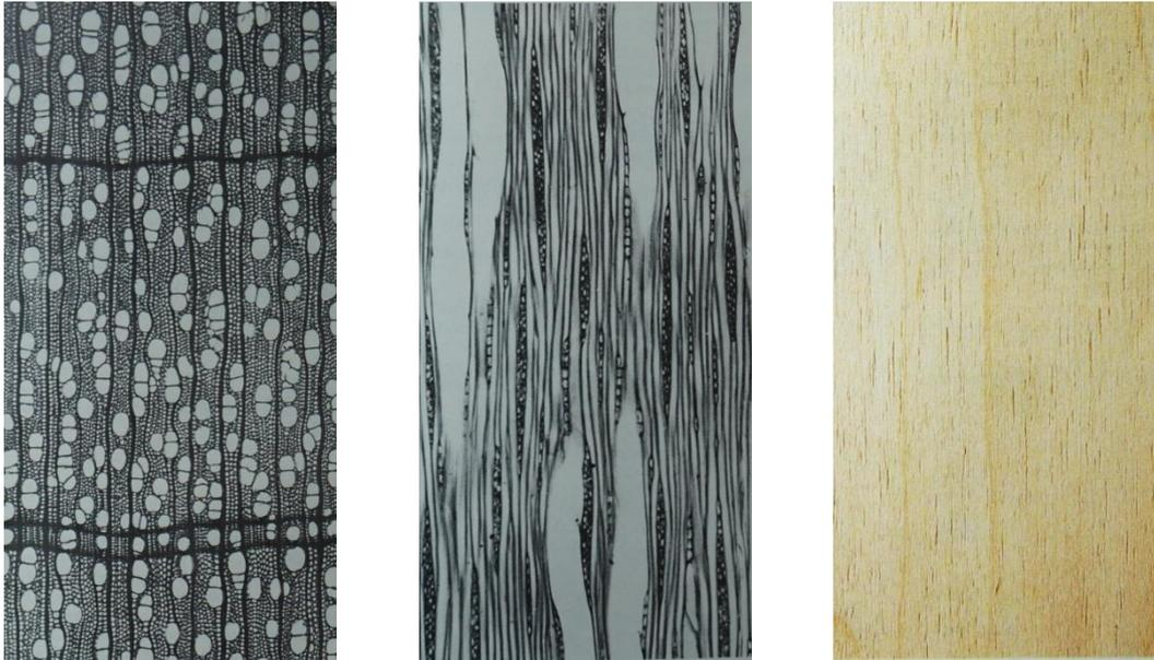
**Abbildung 41: Makroskopische Struktur der Birke, von links: Querschnitt, Tangentialschnitt und Schälfnur (Tangentialschnitt) (Wagenführ, Scheiber, 1985)**
