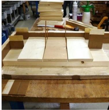
Einlegen des Prüfkörpers und der Füllhölzer
