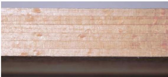
*Abbildung 80: 6-schichtiger Aufbau aus 3,0 mm Buchenfurnieren, Querschnitt*
