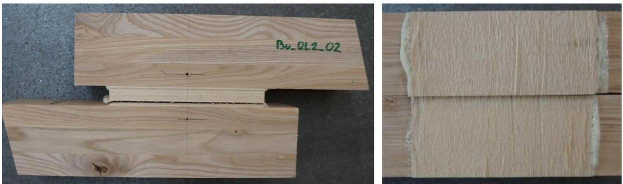
*Abbildung 134: typische Versagensbilder, Buche 11-schichtig mit 2 Querlagen (Schicht 2, 10)*
