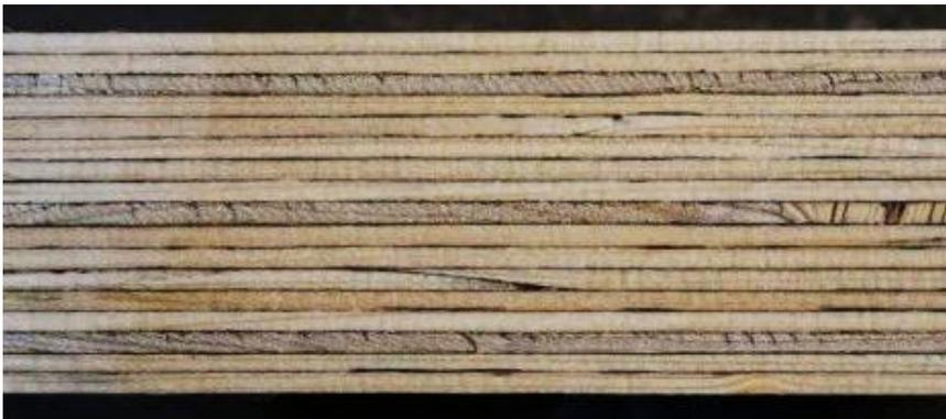
*Abbildung 65: Schäftung bei einer Furnierschichtholzplatte "Kerto S"*
