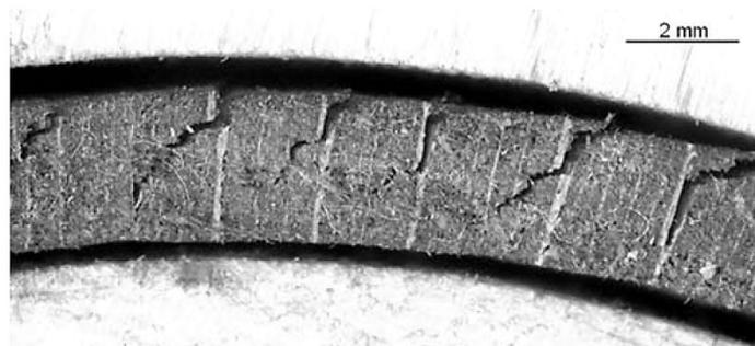
**Abbildung 49: Seitenansicht von gerissenen Furnieren unter dem Mikroskop (Palubicki et al., 2010)**
