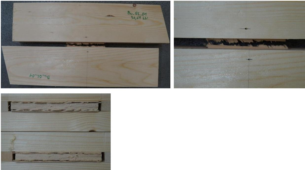
Abbildung 139: typische Versagensbilder, Buche 11-schichtig mit 2 Querlagen (Schicht 2,10)
