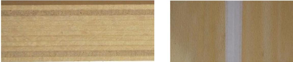
*Abbildung 82: links: 11- schichtiger Aufbau aus 1,5 mm Buchenfurnieren, Querschnitt, inklusiver zweier Querlagen; rechts: fügen der Längslagen mittels Furnierband*
