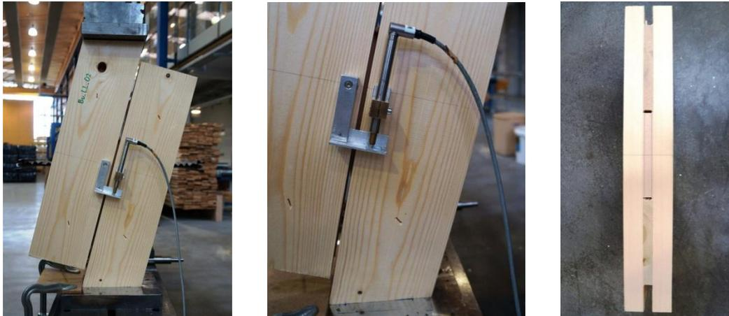
**Abbildung 106:** links: anbringen der Halterung für die Wegaufnehmer; Mitte: Leithölzchen zur Zentrierung des Prüfkörpers; rechts: Seitenansicht des Systemprüfkörpers
