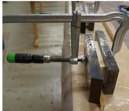
Verkleben des Prüfkörpers mit den Stahllaschen
