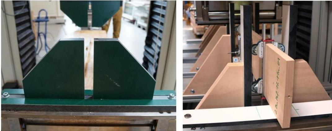
Abbildung 89: links: Kipphalterungen der Serie 1; rechts: Kipphalterungen der Serie 2
