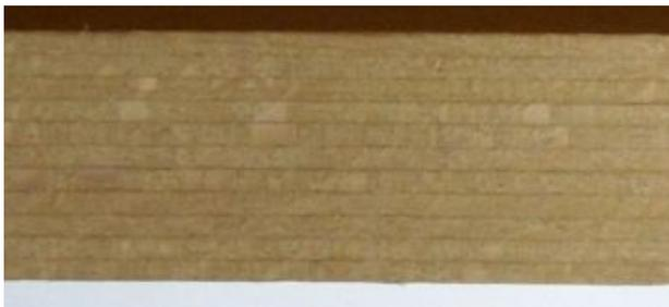
*Abbildung 81: 11-schichtiger Aufbau aus 1,5 mm Buchenfurnieren, Querschnitt*
