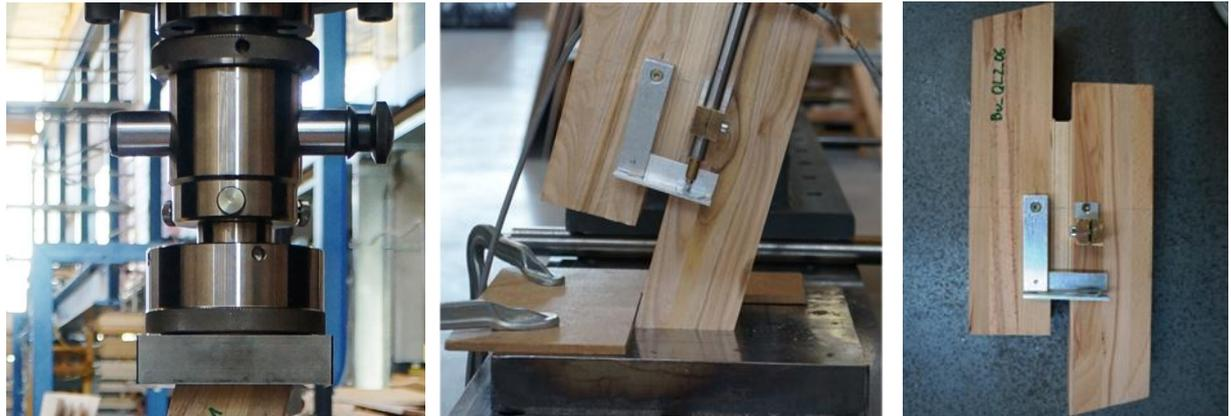
**Abbildung 102:** links: anbringen der Halterung für die Wegaufnehmer; Mitte: Leithölzchen zur Zentrierung des Prüfkörpers; rechts: Systemprüfkörper inklusive der Befestigungen für die Messeinrichtung
