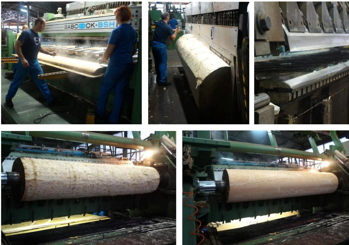
Abbildung 67: oben: Messern eines Fichtenstammes; unten: Schälen eines Fichtenstammes im Furnierwerk "Merkscha furnirnica"
