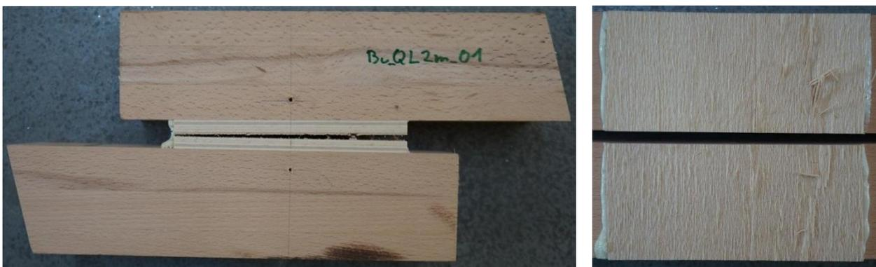
Abbildung 136: typische Versagensbilder, Buche 11-schichtig mit 3 Querlagen (Schicht 2, 6, 10)
