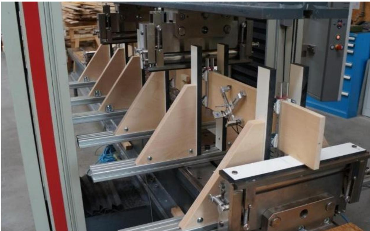
Abbildung 86: Prüfkonfiguration bei Hochkantbiegeprüfungen
