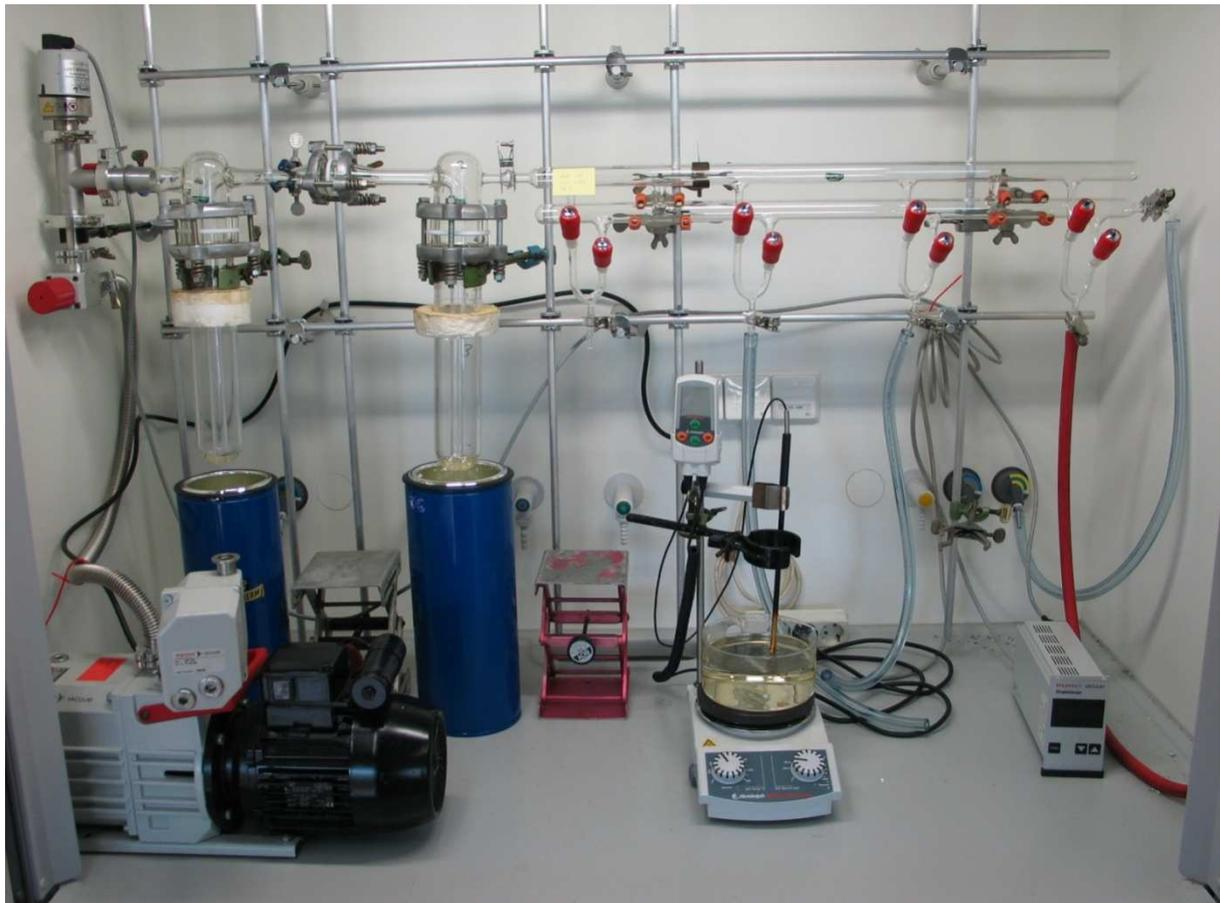
Abbildung 1: Teflon-Vakuumpumpe mit 2 Kühlfallen und Öl-Drehschieberpumpe.
