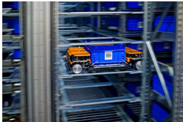
Abbildung 4.9.: Foto eines im Regal fahrenden AiVs [YLOG 2011]
