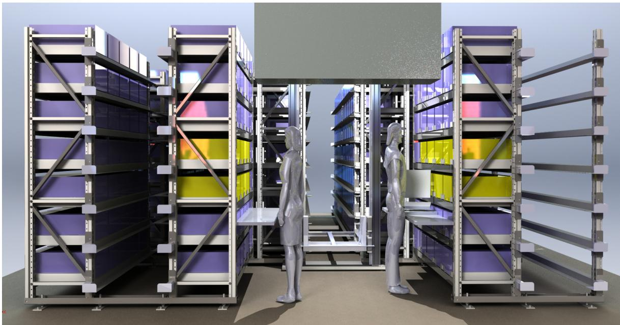
Abbildung 4.14.: Kommissionierbereich: gelbe Behälter sind zugreifbar [Konstruktionsabteilung YLOG]
