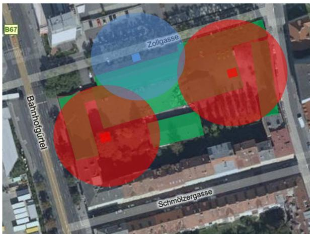
Abbildung 36: Schematische Darstellung der Kranstandorte während der unterschiedlichen Bauphasen<sup>263</sup>
