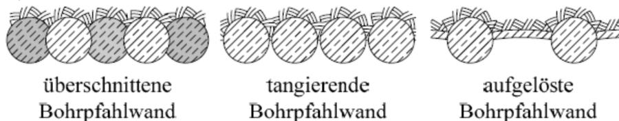
Abbildung 10: Bohrpfahlwand<sup>45</sup>
