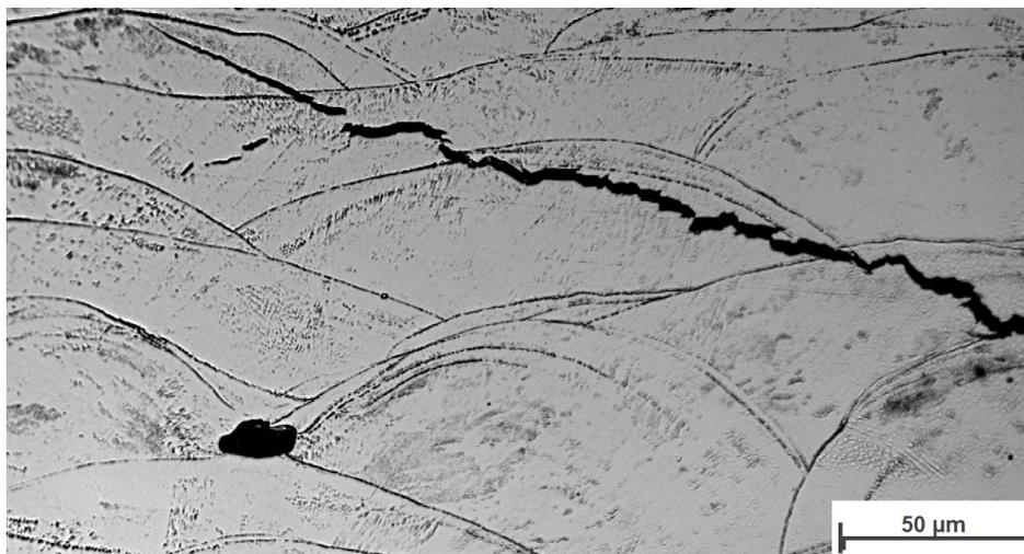
Abbildung 5.40: Schichtaufbau des lasergeschmolzenen Materials
