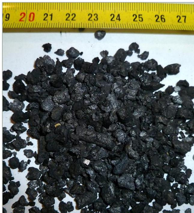
**Abbildung 5-20: Restkoks aus dem Laborvergaser**
