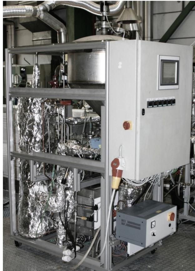
**Abbildung 5-19: Laborvergaser**
