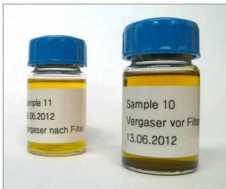
**Abbildung 6-1: Flüssigproben des Vergasergases**
