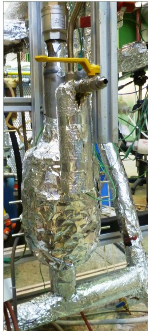
**Abbildung 5-17: Hochtemperatureschwefelungsreaktor**
