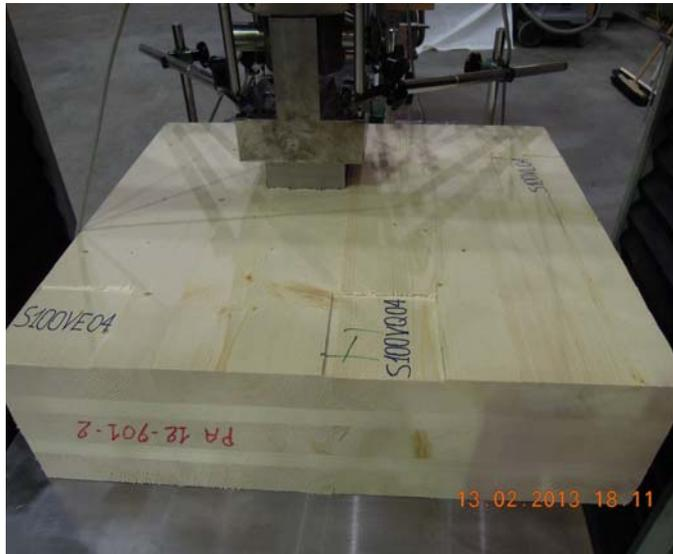
Abb. 2.2 Ermittlung der Querdruckkenngrößen an Platten
