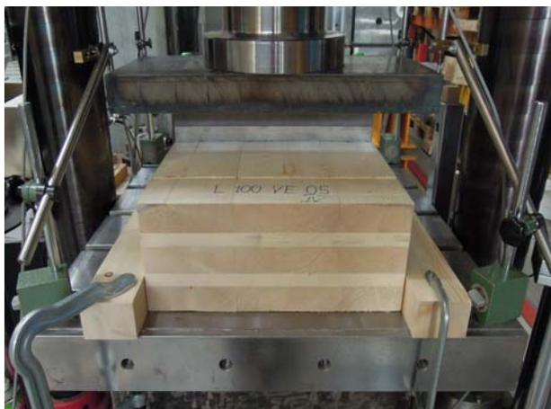
Abb. 2.13 Prüfkongfiguration für Plattenpfungen an der 1 MN-Prüfmaschine des Labors für Konstruktiven Ingenieurbau an der TU Graz
