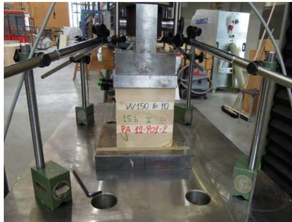
Abb. 2.1 Ermittlung der Querdruckkenngößen an Würfeln
