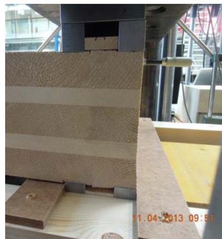
Abb. 2.6 Die drei Konfigurationen in den Fotos stellen Prüfungen an der Kontaktfuge „Wand-Decke“ bzw. Wand-Decke-Wand mit verschiedenen Varianten für eine 3-schichtige Wand (Konf. „a, b, c“) dar
