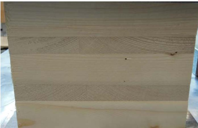
Abb. 1.27 Untersuchtes BSP-Element mit Aufbauparameter 1/3
