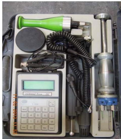
Abb. 2.16 Holzfeuchte Messgerät „Hydromette M 4050“
