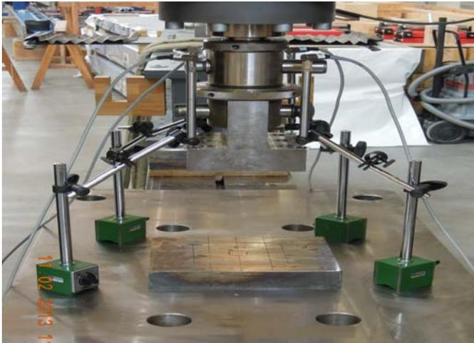
Abb. 2.12 Prüfkongfiguration für Würfelpfungen an der Prüfmaschine Zwick Universal 275 am Lignum Test Center des Instituts für Holzbau und Holztechnologie der TU Graz
