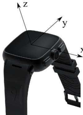
Abbildung 4.7: Achsenorientierung der Smartwatch
