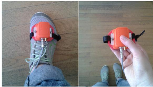
Abbildung 5.2: Positionierung der Xsens MTi-G am Körper (linkes Bild: Positionierung am Fußrücken; rechtes Bild: Positionierung in der Hand)
