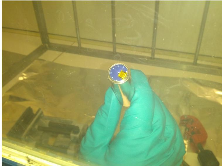
Abbildung 11: Lithium-Ionen-Zelle mit entferntem Pluspol.
