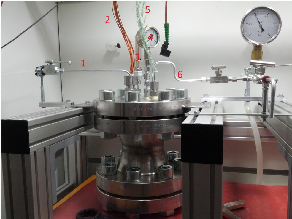
Abbildung 7: Vollständig angeschlossener Druckreaktor. 1 - Gasleitung für Argon 2 - Anschlüsse für die Heizung 3 - Überdruckventil 4 - Manometer zur Relativdruckmessung. 5 - Typ K Thermoelemente 6 - Gasleitung für Ventgas.
