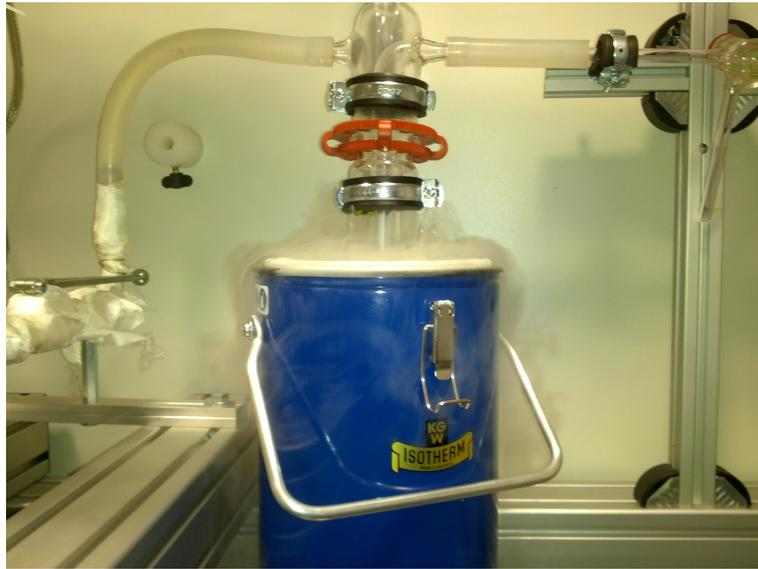
Abbildung 10: Mit flüssigen Stickstoff gefüllte Kühlfalle in der während des Absaugvorgangs durch die Vakuumpumpe ein Teil des Ventgases kondensiert.
