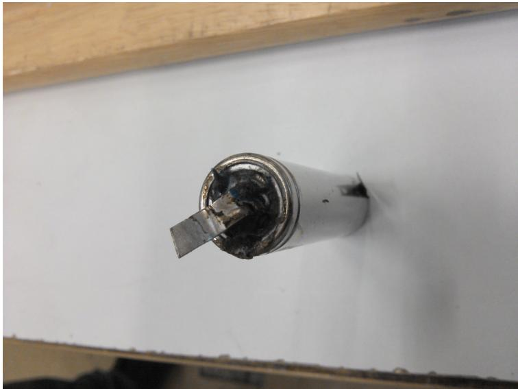
Abbildung 24: Zerstörte LFP-Zelle nach dem Thermal-runaway.
