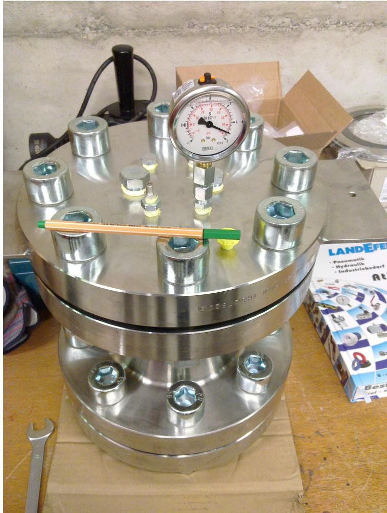
Abbildung 6: Druckreaktor mit Flansch. Die mit gelben Teflonband abgedichteten Bohrungen in der Mitte dienen zur Durchführung der Thermoelemente und der Heizleitungen sowie zum Anschluss des Manometers und des Überdruckventils.
