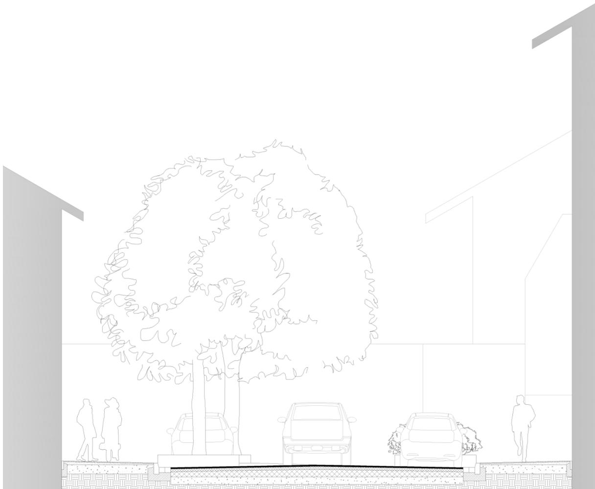
Abb. 72: Systemschnitt Straßen- und Gehwegaufbau
