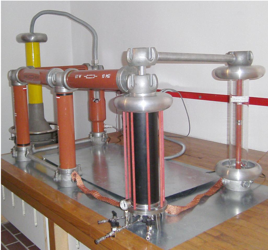
Abbildung 4.3.2: Foto des Gleichspannungsprüfkreises mit dem Entladungsgefäß (vorne)
