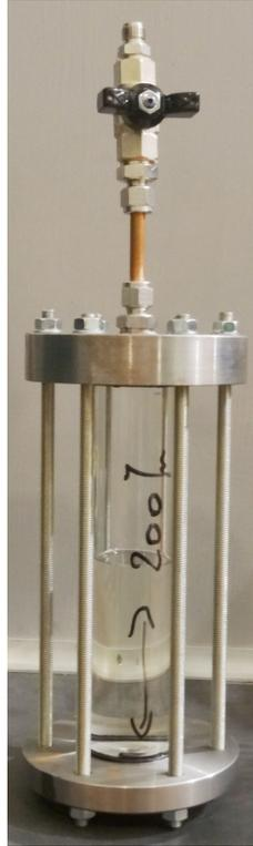
Abbildung 4.1.3: Flüssigkeitsbehälter
