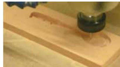
Scannen und gleichzeitiges Fräsen eines Kaffeelöffels
