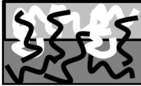
**Abb. 6:** Schema der Interdiffusions-Adhäsionstheorie.<sup>[12]</sup>
