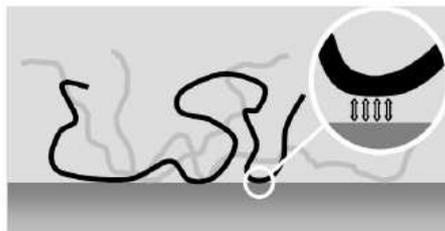
**Abb. 4:** Schema der physikalischen Adsorptionstheorie.<sup>[7]</sup>
