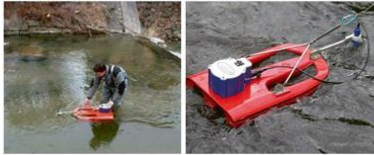
Abbildung 9.9 Flachwasser-ADCP StreamPro. (Morgenschweis, 2010)
