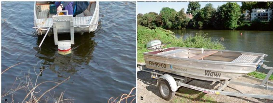
Abbildung 9.5 Aluminiumboot als Geräteträger. a Messung mit Ausleger. b Messboot auf Trailer. (Morgenschweis, 2010)
