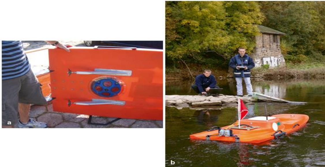
Abbildung 9.6 Ferngesteuertes Boot, Typ Q-Boat von Oceanscience. a ADCP-Gerät und Bootsantrieb b im Messeinsatz. (Morgenschweis, 2010)
