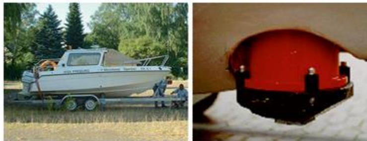
Abbildung 9.4 Trailerbares Kunststoffboot mit ADCP-Messschacht. (Adler, 2008a)
