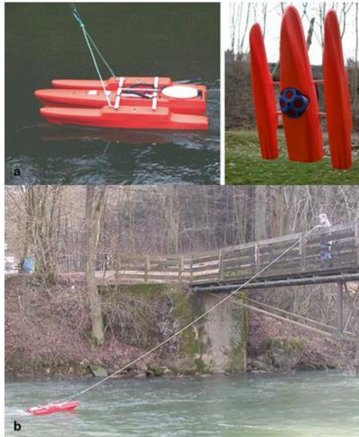
Abbildung 9.7 Trimaran als ADCP-Geräteträger mit a 1200 kHz- ADCP Workhorse Rio Grande
