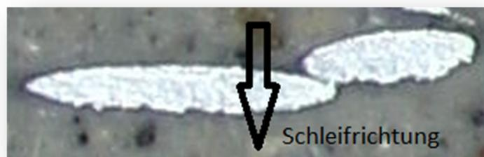
Abbildung 23: Einfluss der Schleifrichtung (nach dem Polieren per Hand mit einer  $30 \mu$  Schleifscheibe)
