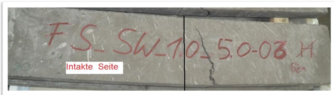
Abbildung 45: Beispielkörper mit gekennzeichnete intakter Seite zur Entnahme des Probekörpers
