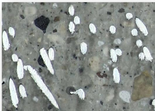
Abbildung 15: Geschliffene Probe(Ceracem)
