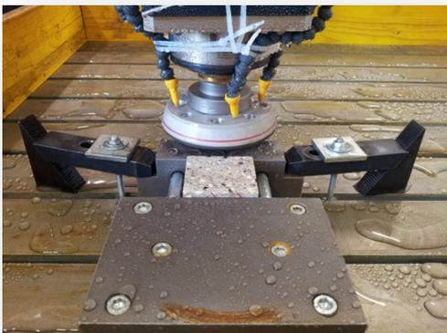
Abbildung 14: Schleifen einer Probe (Ceracem)
