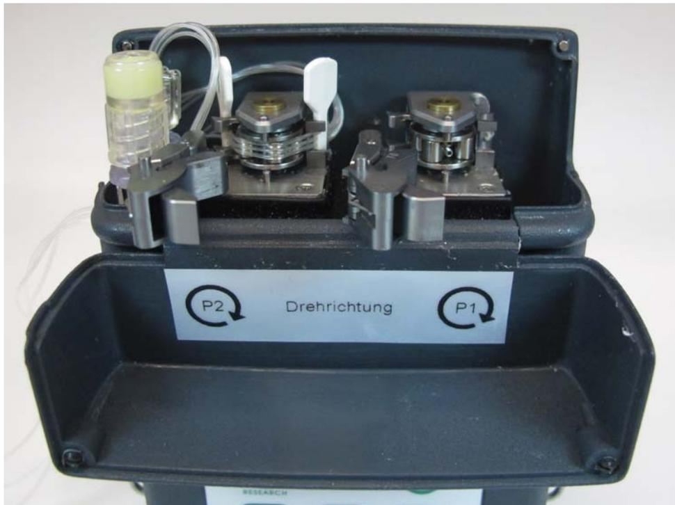
**Abbildung 2.2:** Detailfoto der dOFM Pumpe
