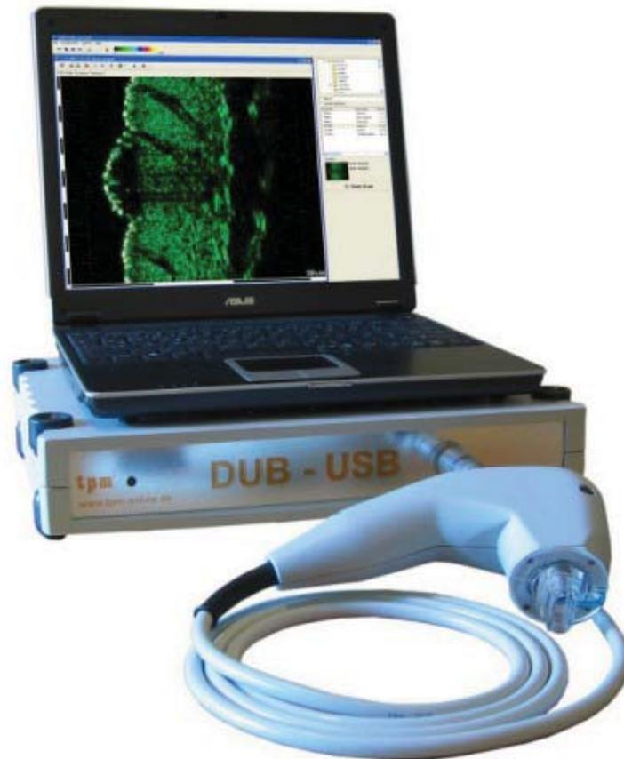
**Abbildung 2.19:** Ultraschallsystem für die Dermatologie
