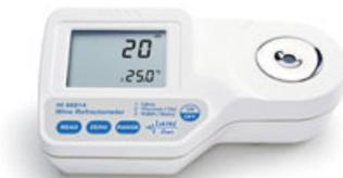
Abbildung 3.1: Refraktometer, Hanna Instruments
