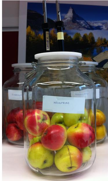
Abbildung 5.5: Exposition der SPME PDMS Faser mittels PFS
