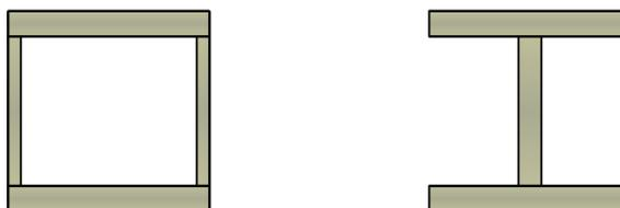
Abbildung 3.2: Kastenquerschnitt (links); I-Querschnitt (rechts)
