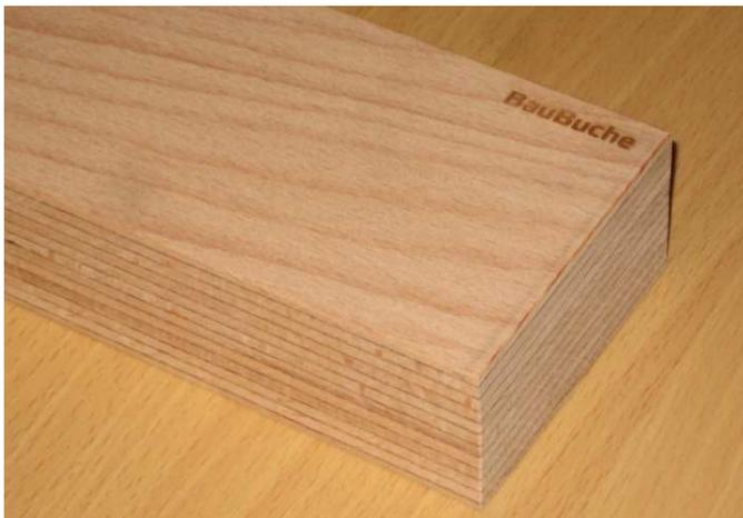
**Abbildung 1.2: Foto eines Furnierschichtholzes „Buchen-FSH längslagig“ (BauBuche)**
