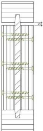
Bei bestimmten Anschlusssituationen (z.B. mit hoher Querkraftbelastung) können Stegverstärkungen die Tragfähigkeit verbessern. Dazu werden links und rechts vom Steg Holzwerkstoffplatten, z. B. Kerto-Q, angebracht und diese mittels Nagel oder Schrauben mit dem Steg verbunden. Eine Verklebung der Stegverstärkung erhöht die Steifigkeit. Die Holzwerkstoffplatten sollten mit einem Abstand von ca. 5 mm zum oberen oder unteren Gurt eingebaut werden (siehe Darstellung daneben).
