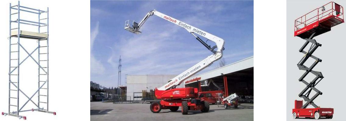
Abbildung 6.21: Steighilfen – Montagegerüst (links); Steiger (Mitte); Scherensarbeitsbühne (rechts)
