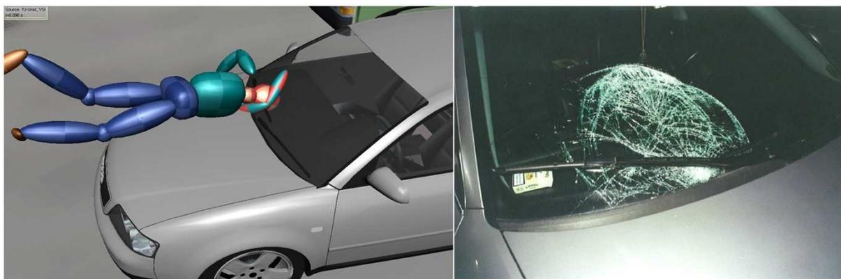
Abbildung 34: Kopfanprall rekonstruiert in PC-Crash und original Polizeifoto der Verformung am Fahrzeug
