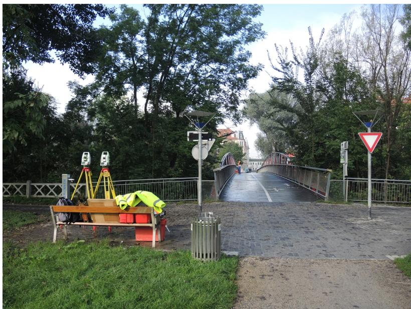
Abbildung 7.2: Messaufbau der Totalstationen
