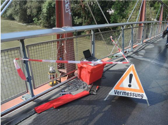
(a) Messaufbau der Beschleunigungssensoren
