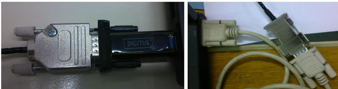
Abbildung 5.39: USB Adapter (links) vs. Serieller Adapter (rechts)
