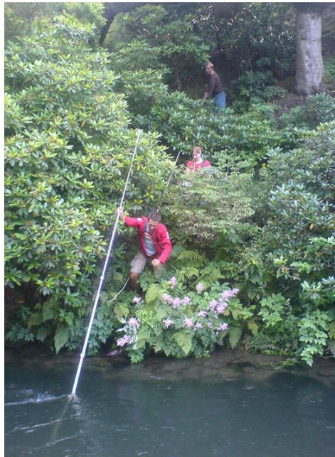
Abb. 18: Geschwindigkeitsmessung im Oberwassergerinne
