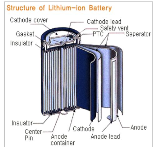
Abbildung 3: Aufbau einer Lithium-Ionen Batterie <sup>(58)</sup>
