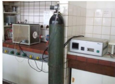
Abbildung 22: Apparatur zur Synthese der Aktivmaterialien
