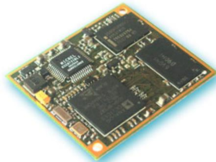
**Abbildung 3.13.:** Das Core-Modul *CM-BF527*[42] von *Bluetechnix*
