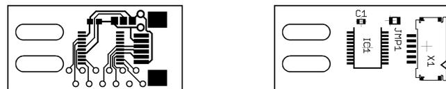
**Abbildung A.31.:** Top-Layer von Encoder Adapter v1.0
