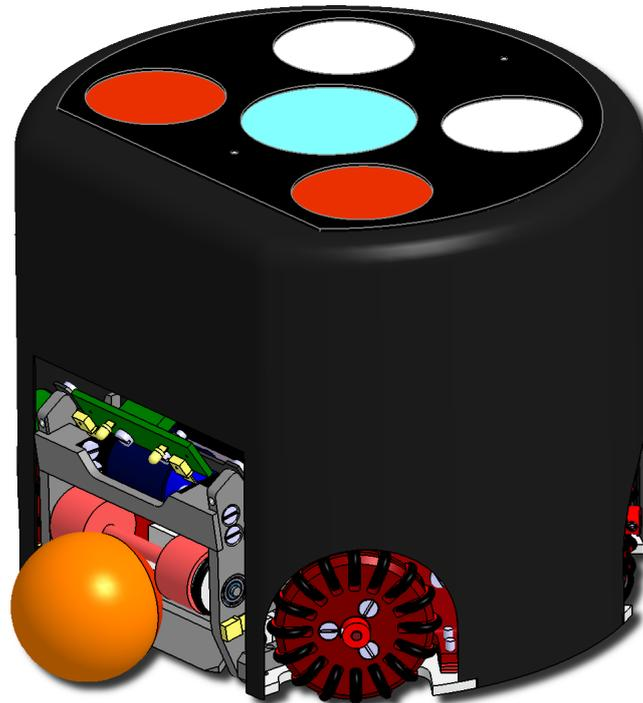
**Abbildung 3.21.:** Position der Lichtschranken am Roboter (grüne Platine mit gelben Komponenten)
